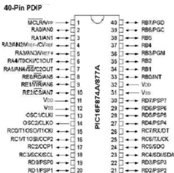
**Figure 4B** 16F877A PIC MICROCONTROLLER PIN DIAGRAM
