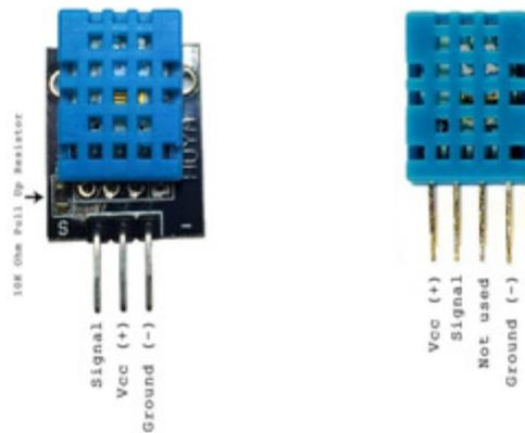
**Figure 7** Pin out versions of DHT11 sensor
