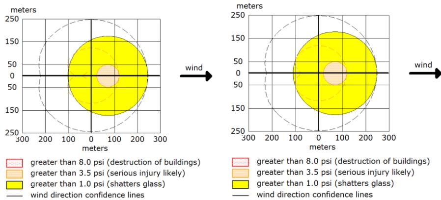
**Figure 9** Bullet Vapour Cloud Explosion **Figure-10:** Tanker Vapour Cloud Explosion
