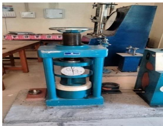
**Figure 5** Split Tensile Test
